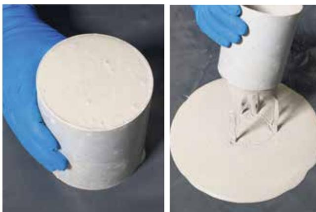
A consistência da betonilha autonivelante é apropriada se no teste o diâmetro corresponder conforme a tabela abaixo.
